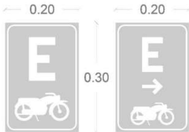
Figura 1.6.1a – Señalización para estacionamiento de motocicletas.
